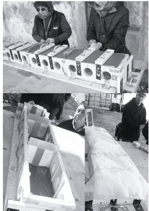
FIGURA 7 | Capacitación en obra para fabricación de ladrillos con cascotes de la propia demolición y EPS reciclado. Fuente: Arqs. Caruso y Yajnes.
