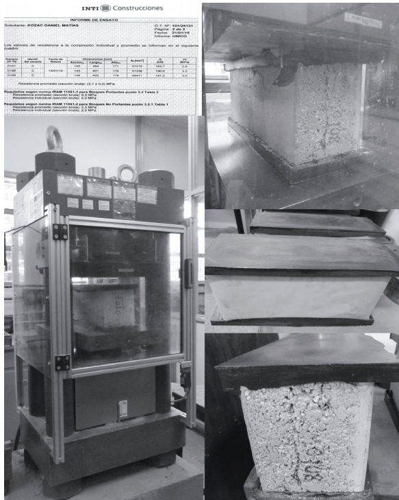
FIGURA 8 | Ensayo de compresión de bloques en INTI. Fuente: Arqs. Caruso y Yajnes.
